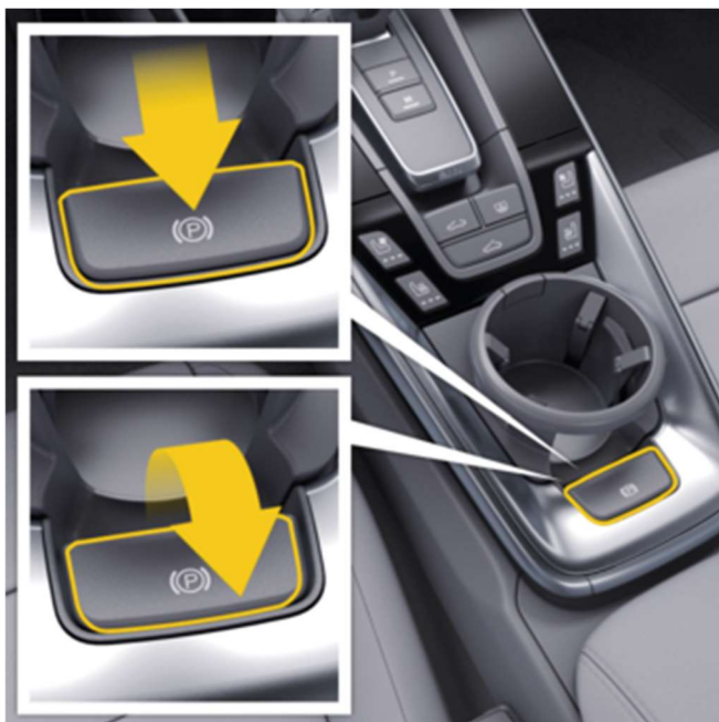
Obr. 1 – Ovladač parkovacího (nouzového) brzdění EPB
