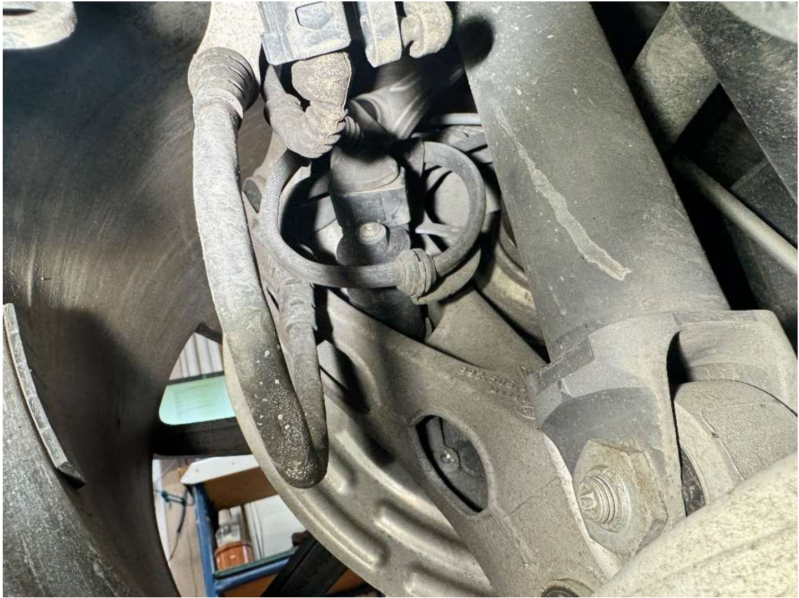
Obr. 3 – Pohled na levé kolo s elektromotorem EPB
