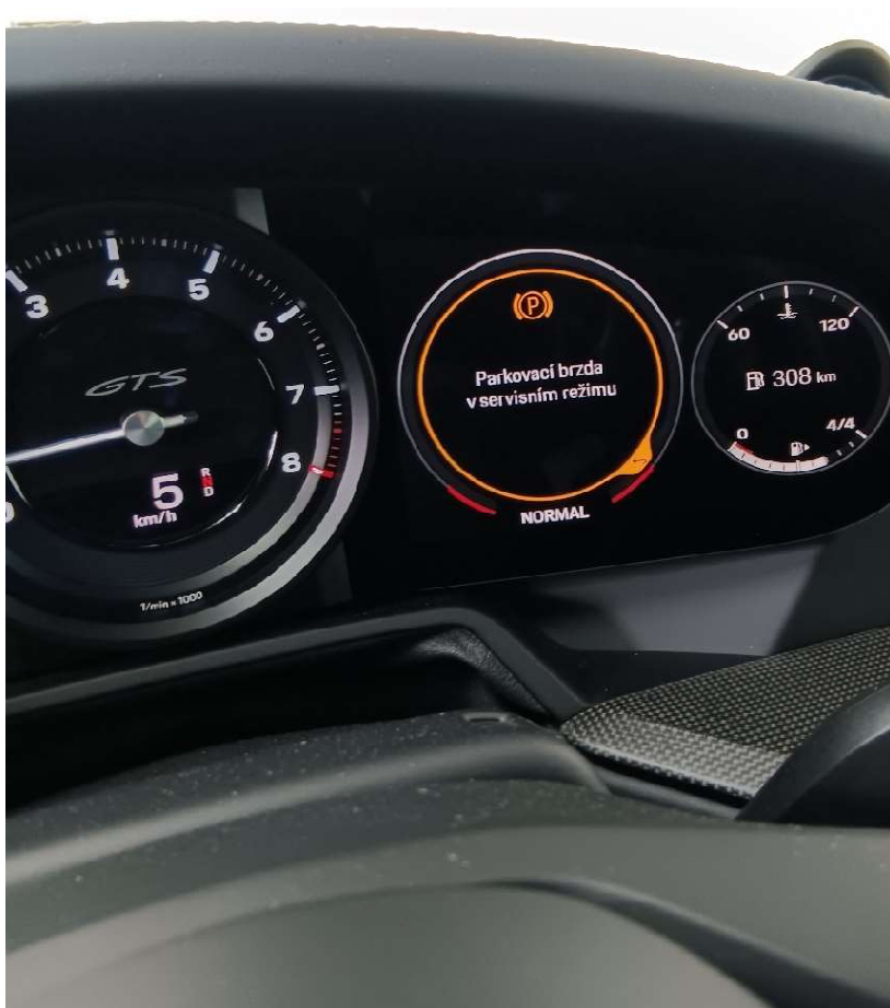
Obr. 5 – Sdělovač s textem „Parkovací brzda v servisním režimu“
